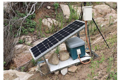
現場には電源が無いので、試行錯誤を重ねて構成したソーラーパネルで電力を自給する
